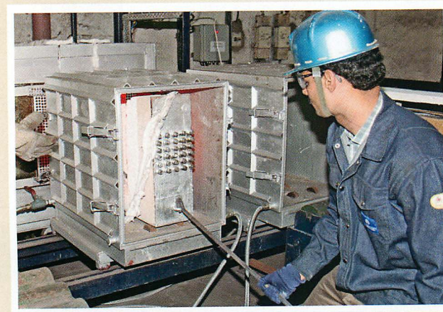
25 kg mini pilot oven for coke making
